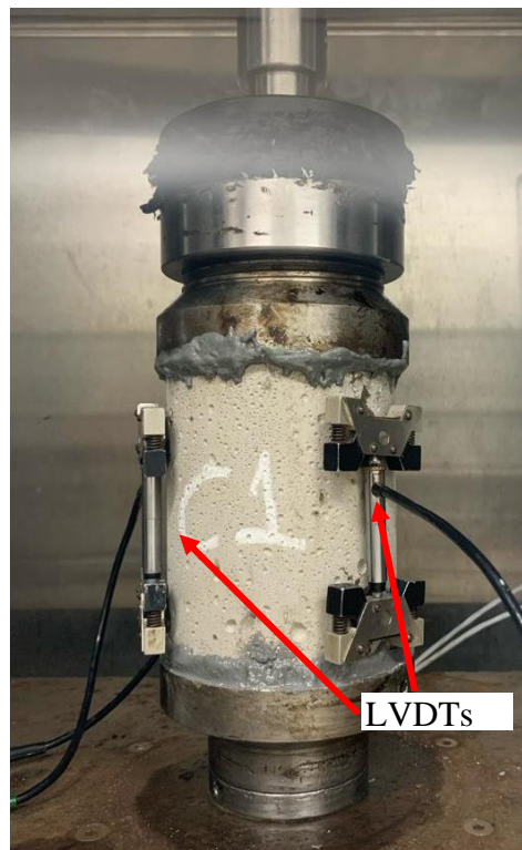
Figura 26 – Montagem do CP para realização do ensaio de fadiga
