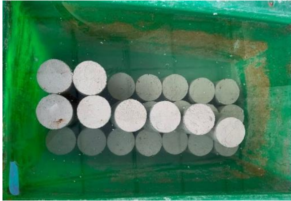
Figura 21 – Cura úmida dos CPs de argamassa
