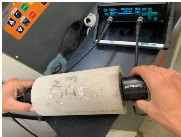
Figura 22 – Determinação da velocidade e do tempo de voo da onda ultrassônica, no corpo de prova de argamassa
