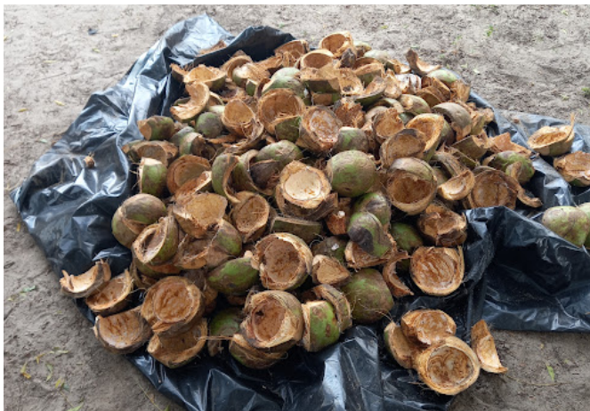
Figura 21 - Cascas de coco em processo de triagem para ser colocada no filtro anaeróbio.
