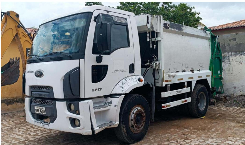
Figura 18 - Veículo compactador próprio de 10,8 toneladas usado para coleta domiciliar.
