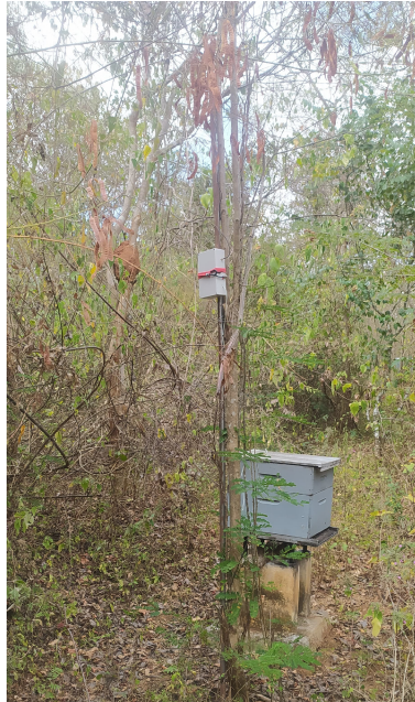
Figura 36 – Dispositivo sensor instalado no ambiente apícola.
