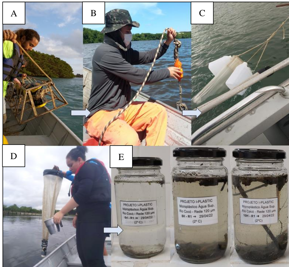
Figura 7 - Etapas de amostragem de microplásticos no estuário do rio Cocó. Fundeamento do CTD (A) e do ADCP (B) para coleta de dados oceanográficos; arrasto utilizando a rede de plâncton com malha de 120 \mu\text{m} (C); lavagem do copo da rede e armazenamento de amostras (D); amostras coletadas (E)
