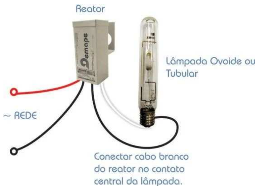
Figura 8 — Esquema de um reator externo
