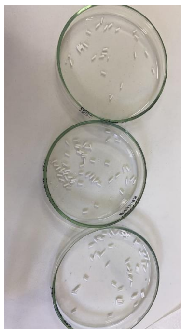
80% de LTA sintetizada (LTAS) e 20% de bentonita
