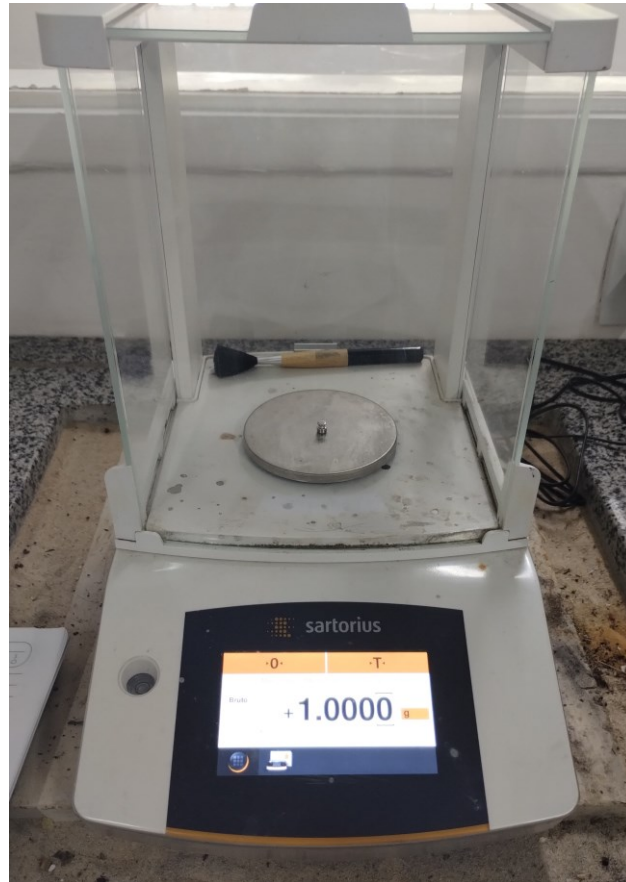
Figura 9 – Balança Analítica medindo o peso padrão de 1,0000 g
