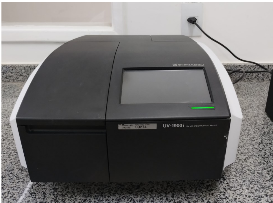
Figura 11 – Espectrofotômetro UV-VIS utilizado nos ensaios de sulfato e nitrato
