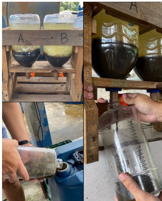
Figura 12 - Decantação, coleta e abastecimento dos biodigestores
