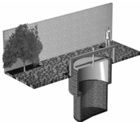
Figura 3 - Biodigestor modelo batelada
