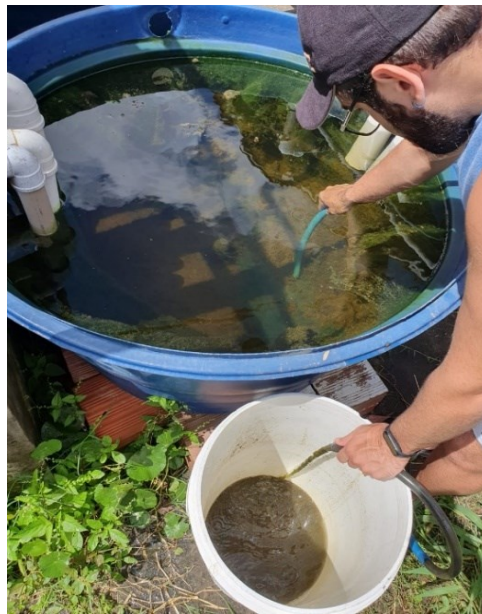
Figura 10 - Procedimento de sifonagem da matéria orgânica presente no decantador
