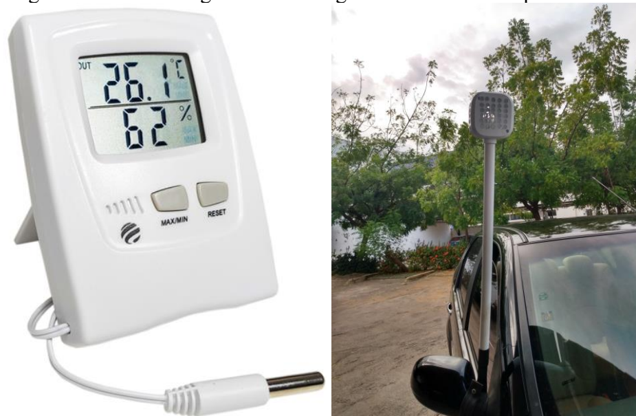
Figura 27 – Termo-higrômetro e abrigo utilizados em campo
