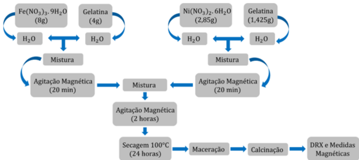
Figura 13 – Fluxograma da sintetização.
