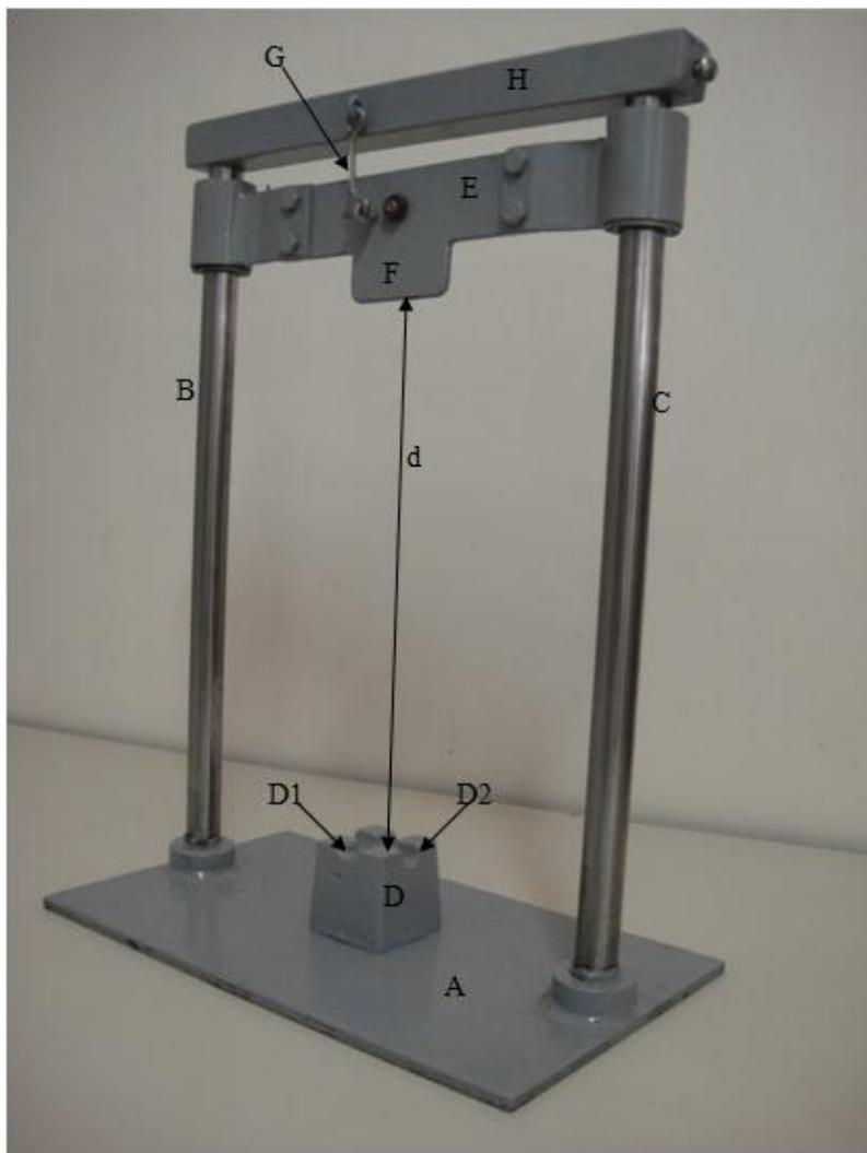
**FIGURA 9** – Aparelho de fraturas. A: base; B e C: hastes cilíndricas; D: plataforma; D1: canaleta transversal; D2: canaleta longitudinal; E: barra de aço deslizante; F: lâmina romba; G: trava; H: barra de aço estabilizadora; d: altura da lâmina romba (274,3mm).
