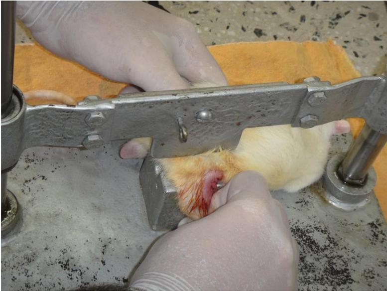
**FIGURA 10** – Posicionamento adequado do fêmur direito no canaleta transversal do aparelho de fraturas.
