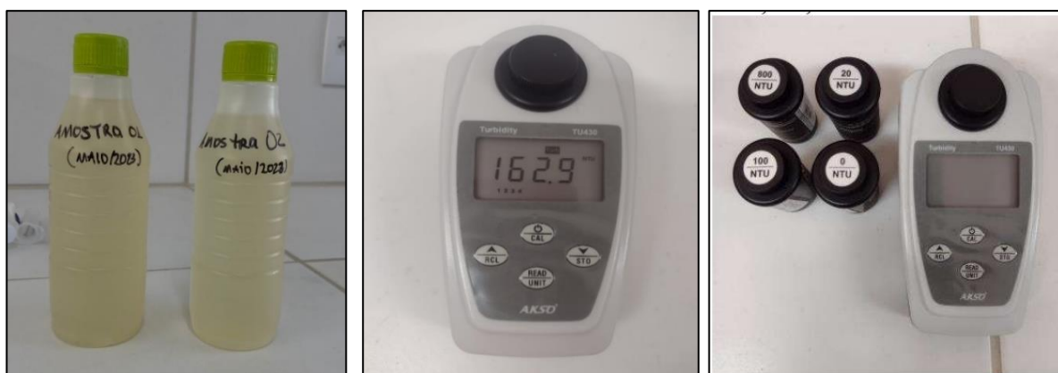
Figura 17a – Amostras 1 e 2 Figura 17b - Turbidímetro Digital TU430 Figura 17c - Soluções padrão de 0, 20, 100 e 800 NTU
