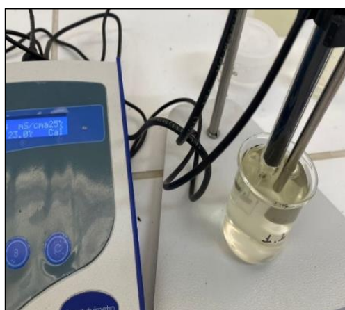
Figura 18 – Procedimento de leitura da condutividade elétrica.
