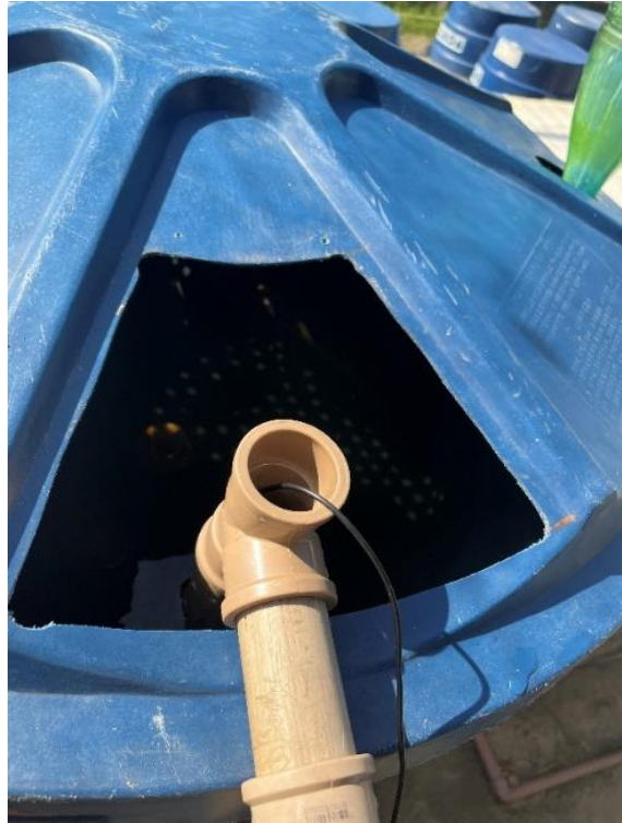
Figura 10 - Cano perfurado para proteção do sensor SEN0237-A
