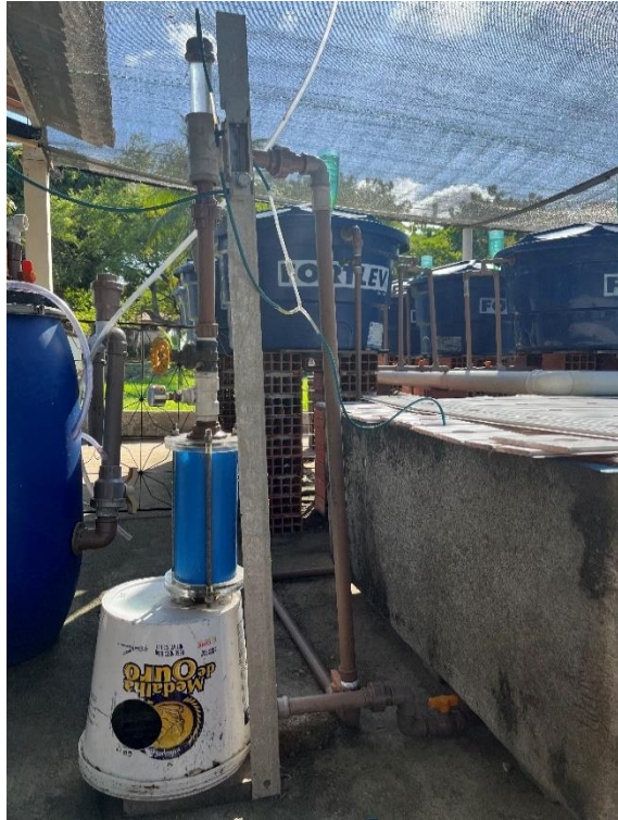
Figura 3 - Gerador de bolhas ultrafinas que recebe oxigênio do concentrador
