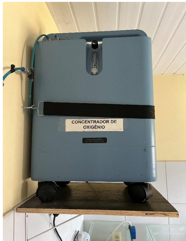
Figura 4 - Concentrador de oxigênio para iniciar a geração de bolhas ultrafinas
