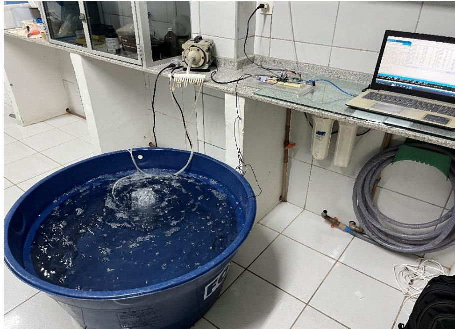
Figura 8 - Tanque circular de 150 L com bomba aeradora para realização do pré-teste do equipamento
