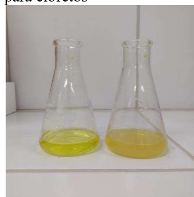
Figura 38 – Comparação visual do ponto de viragem para cloretos
