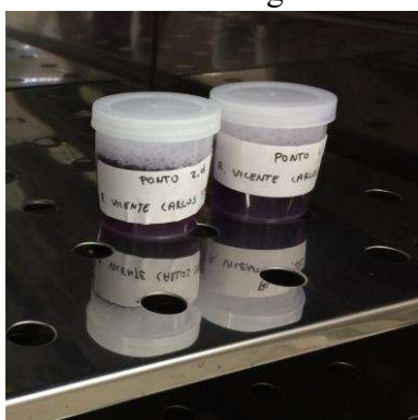
Figura 14 – Amostras microbiológicas com adição do substrato cromogênico
