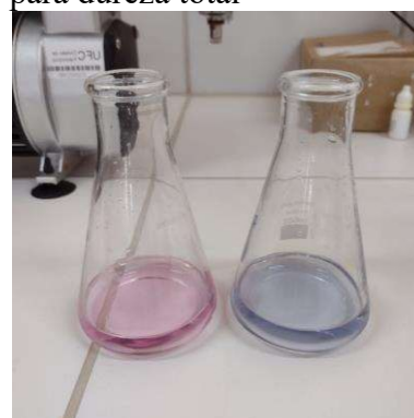
Figura 44 – Comparação visual do ponto de viragem para dureza total
