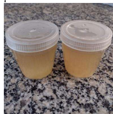
Figura 16 – Coloração amarela indicando positivo para CT
