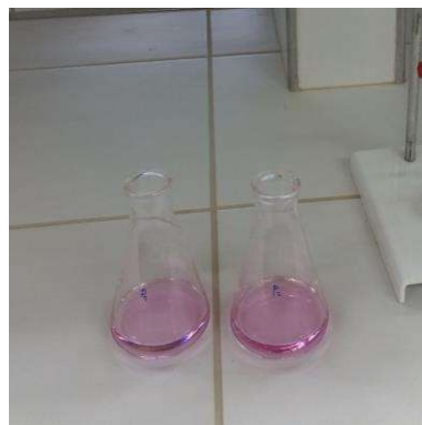
Figura 40 – Amostra após aplicação do indicador preto de ericromo T
