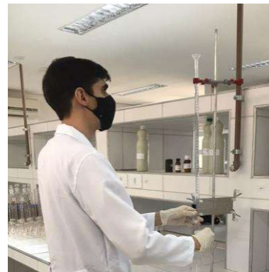
Figura 41 – Preenchimento da bureta com o titulante EDTA
