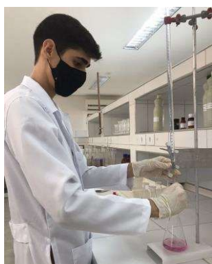
Figura 42 – Início da titulação para dureza total
