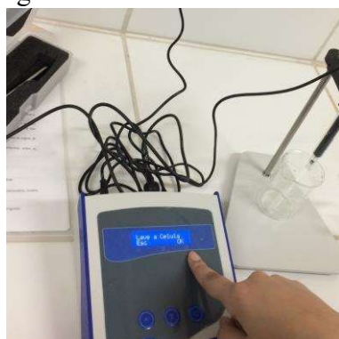
Figura 24 – Lavagem da célula do condutivímetro com água destilada
