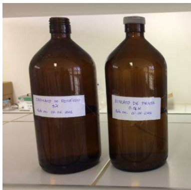
Figura 33 – Titulante e indicador utilizados para análise de cloretos
