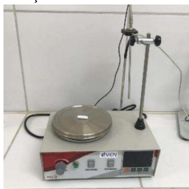
Figura 32 – Agitador magnético utilizado na titulação de alcalinidade
