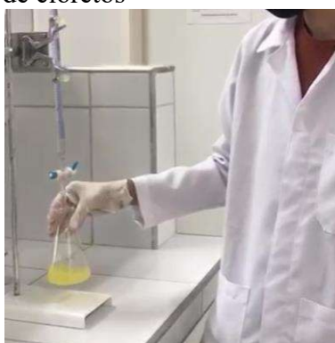
Figura 37 – Momento da viragem e final da titulação de cloretos
