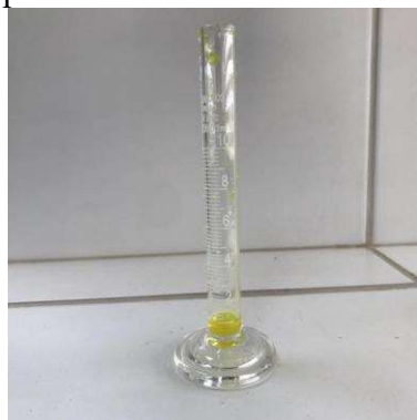
Figura 34 – Medição do indicador cromato de potássio
