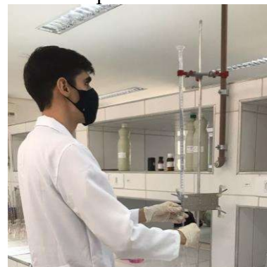
Figura 35 – Preenchimento da bureta com o titulante nitrato de prata
