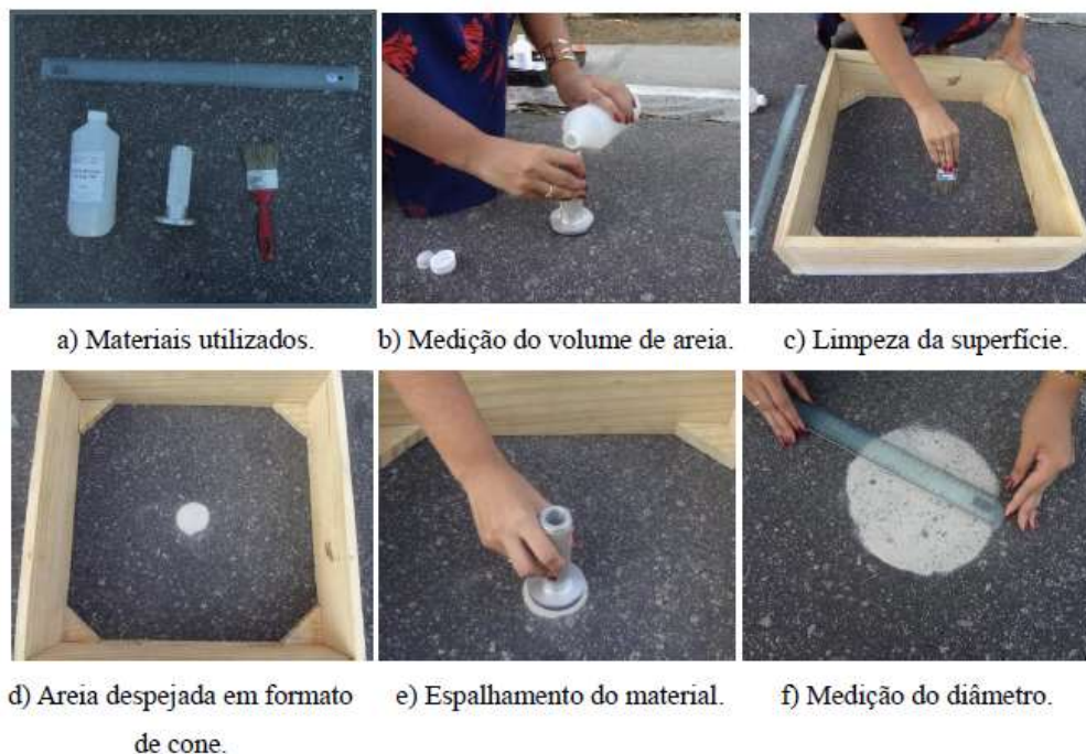
Figura 4 – Ensaio da mancha de areia
