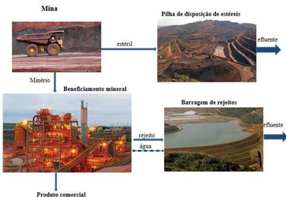
Figura 5 - Esquema de direcionamento geral de rejeitos na mineração
