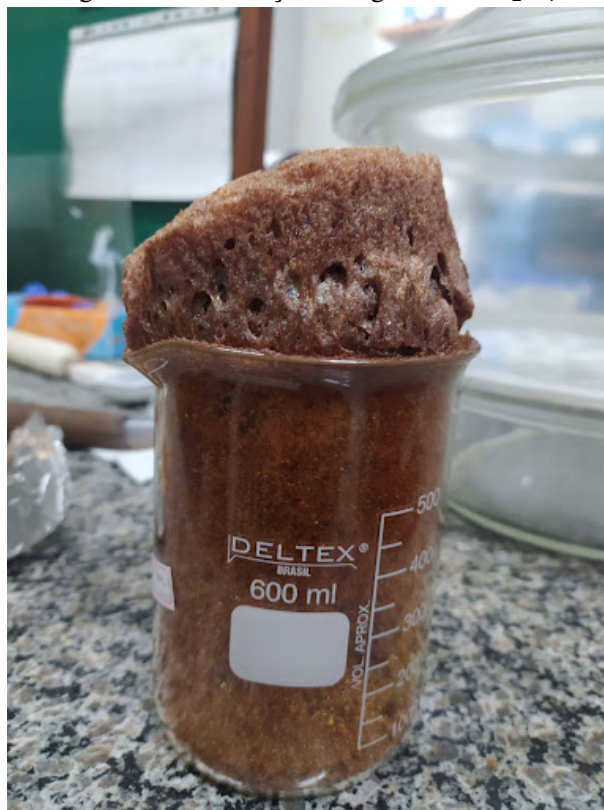
Figura 23 – Formação xerogel da \text{CoFe}_2\text{O}_4 .
