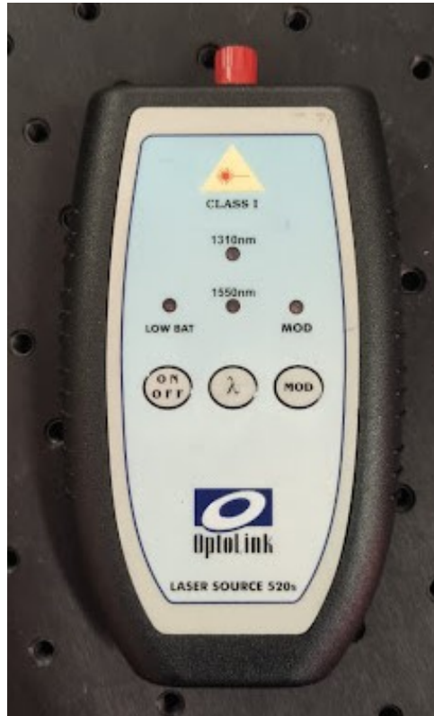
Figura 18 – Fonte de luz portátil 1310/1550 nm.
