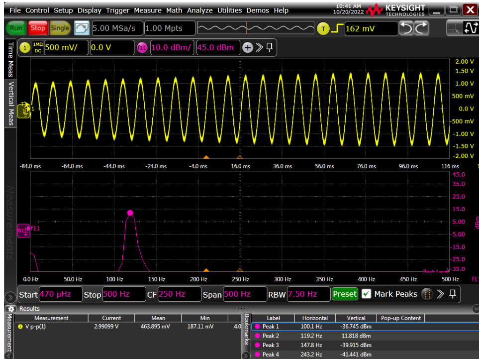
Figura 46 – Resposta do sensor vista no osciloscópio, e a \text{CoFe}_2\text{O}_4 como elemento sensor.
