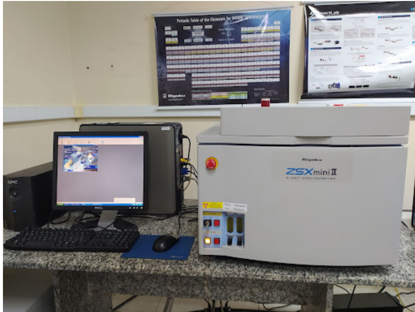
Figura 26 – Espectrometro de fluorescência de raios-X da marca Rigaku e modelo ZSXMini II.
