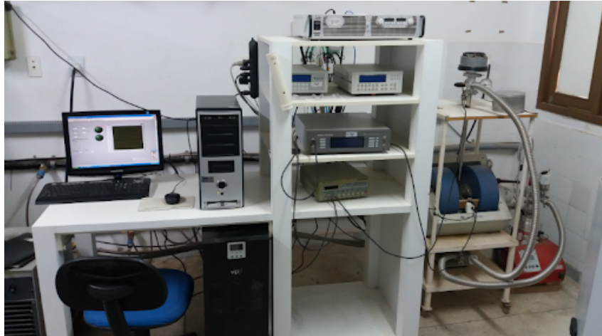
Figura 28 – Magnetômetro de Amostra Vibrante do LAMOp.
