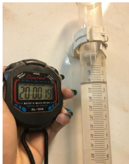
Figura 10: Leitura do desnível da água na bureta em função do tempo, no ensaio de permeabilidade à água utilizando carga variável
