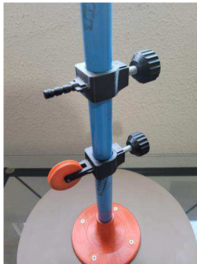
Figura 45 – Base completa com mufas
