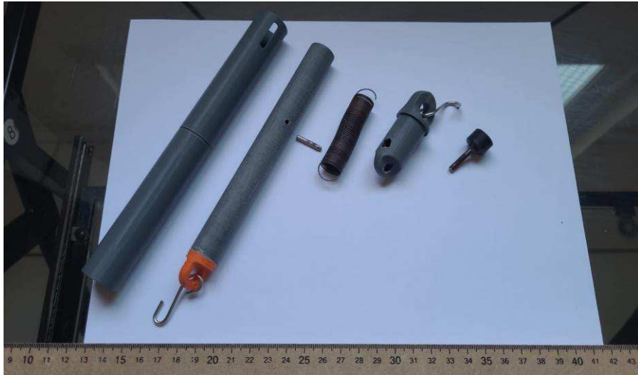
Figura 50 – Peças do dinamômetro impressas, e algumas partes de metal
