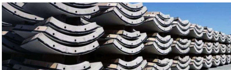
Figura 2 – Revestimento de túneis segmentados reforçados com fibras de aço
