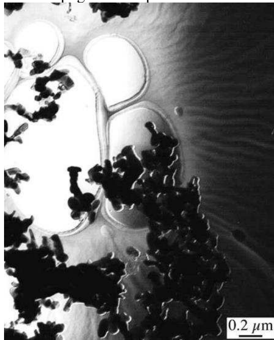
Figura 15 – Contraste topográfico de partículas de Fe 3 O 4 em um carbono
