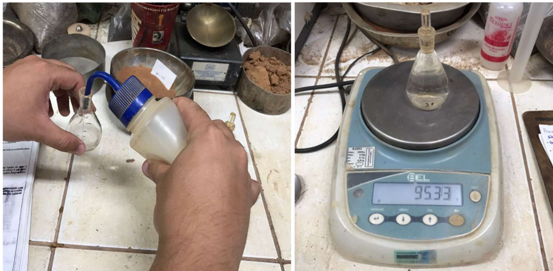
Figura 16 - Adição de água destilada e pesagem do picnômetro.
