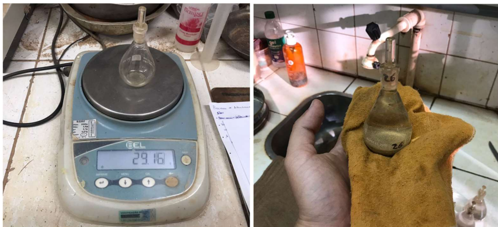
Figura 15 - Processo de pesagem e retirada do aquecimento.
