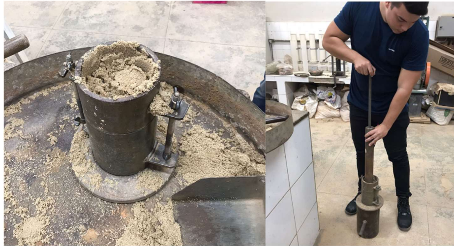
Figura 13 - Compactação com soquete.
