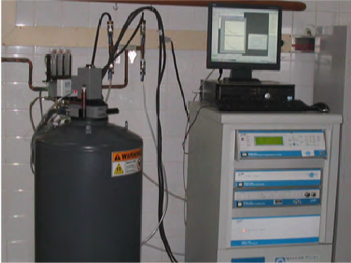
Figura 25 – PPMS do Laboratório de Calorimetria, Transporte e Magnetometria do Departamento de Física da UFPE.
