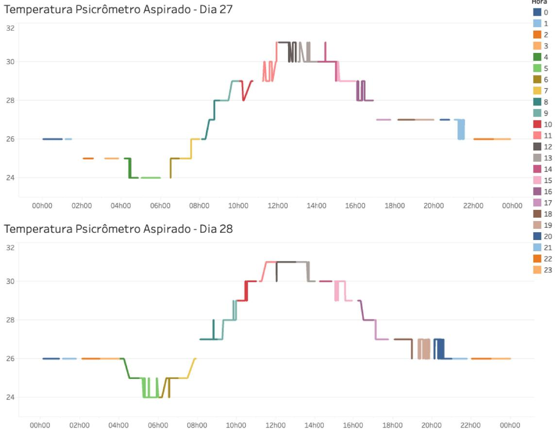
eram por volta de 12h e na estação por volta de 15h/16h. O Sensor Externo 3 apresenta as maiores temperaturas, indicando a forte incidência do sol no período diurno. Já no período noturno, as medições tanto da Estação do Itaperi quanto as dos sensores do experimento se aproximam. O sensor 2, por sua vez, teve nítida instabilidade.
