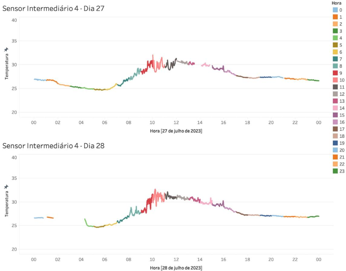
tornando difícil a visualização dos valores, nos mostrando mais uma vez o quanto a exposição solar influencia. As diferenças de temperaturas ocorrendo na presença de exposição solar. Para uma melhor visualização, as Figuras 29 e 31 possuem o detalhamento dos dados para o dia 25.
