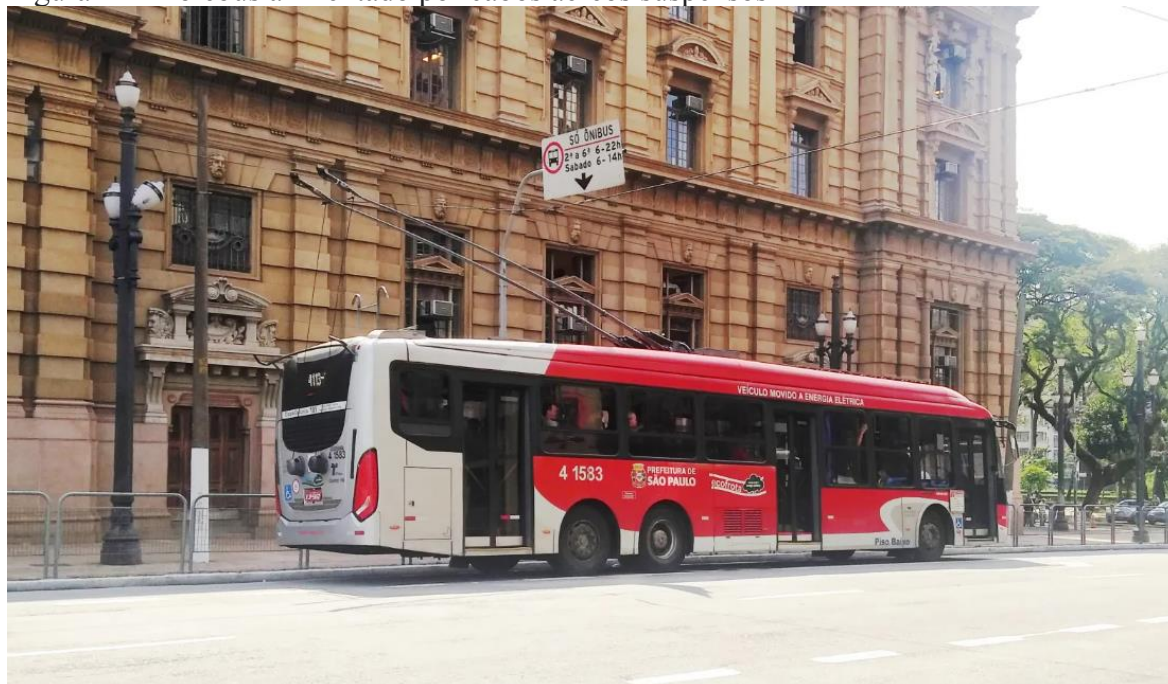
Figura 1 – Trólebus alimentado por cabos aéreos suspensos
