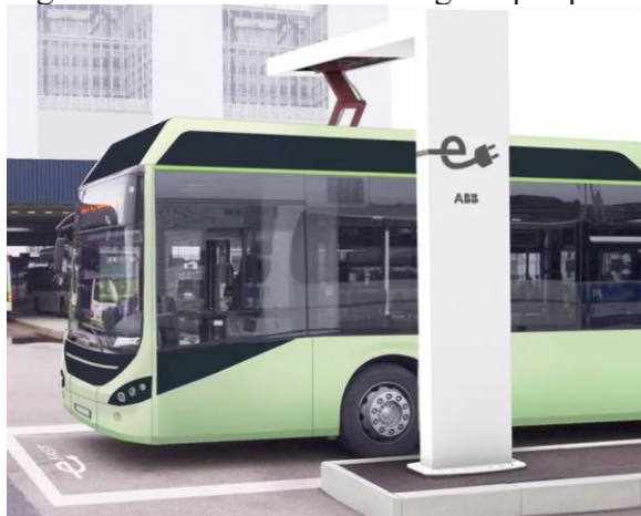
Figura 2 – Ônibus sendo carregado por pantógrafo
