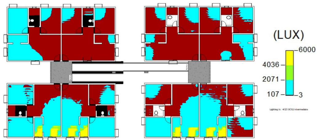
Figura 26 - Resultados da simulação de Iluminância (LUX) conforme a NBR 15575 do pavimento térreo.
