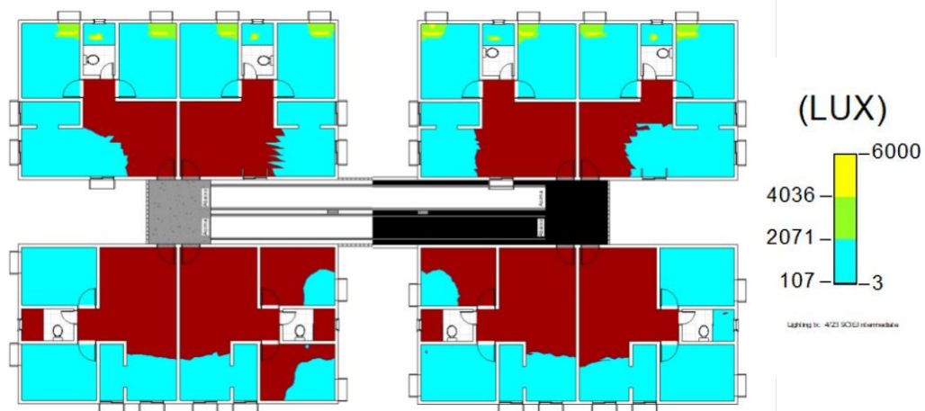
Figura 31 - Resultados da simulação de Iluminância (LUX) conforme a NBR 15575 do 1º pavimento.
