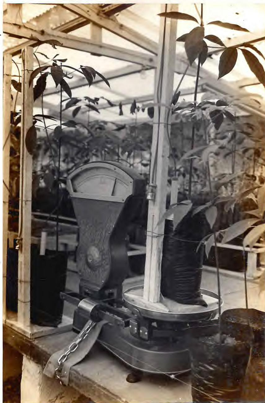
FIGURA 4 - Tensiômetro e Balança Instalados na Casa de Vegetação Destinados a Medir a Evapotranspiração de Porta-Enxerto de Seringueira
