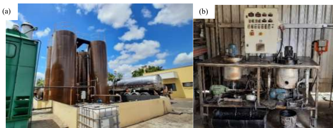
Figura 11 – Planta industrial utilizada na confecção das emulsões asfálticas (a) Empresa Asfaltos Nordeste Ltda; (b) Moinho coloidal piloto
