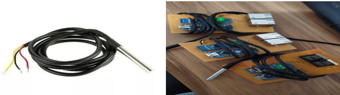
Figura 3 – Sensor de temperatura e controlador
