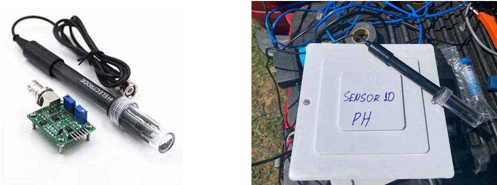
Figura 2 – Sensor de pH utilizado no desenvolvimento do SMRA
