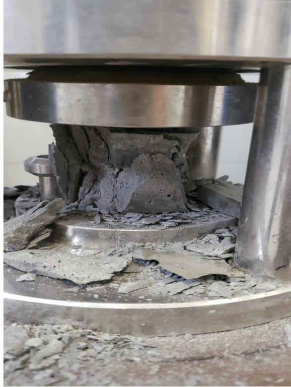
Figura 10 – Fotografia de corpo-de-prova cúbico rompido em ensaio de compressão
