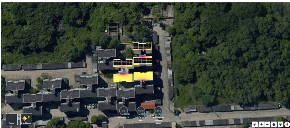
Figura 33 — Layout final dos módulos fotovoltaicos.
