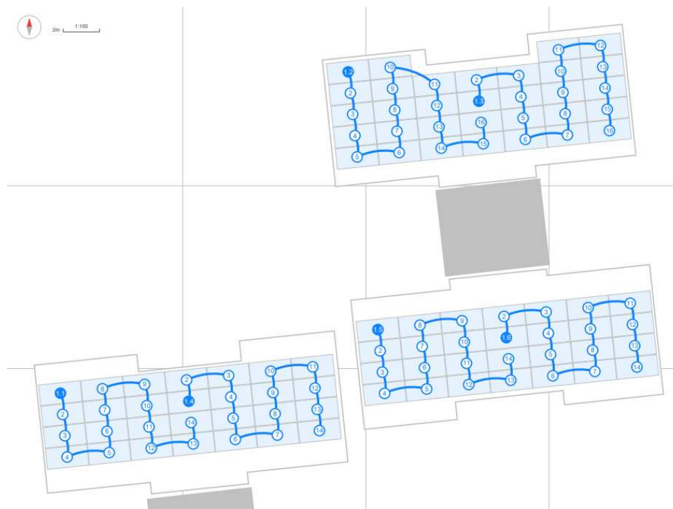
Figura 34 — Layout final das strings fotovoltaicas.
