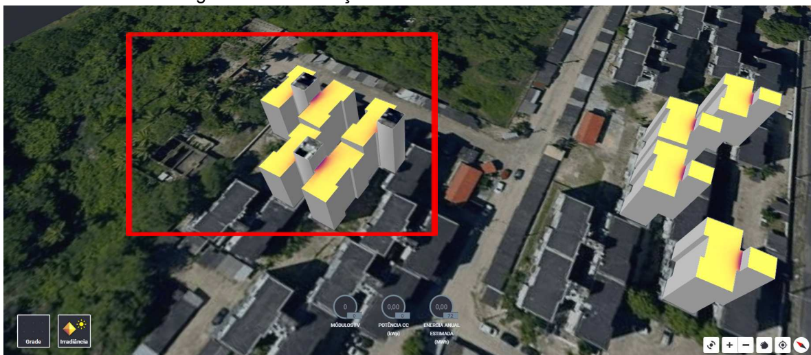
Figura 30 — Simulação de sombreamento dos telhados.
