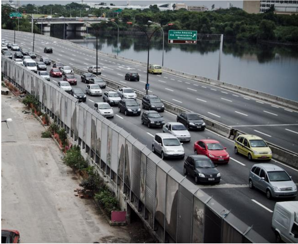
Figura 6 - Barreira acústica na Linha Vermelha no Rio de Janeiro
