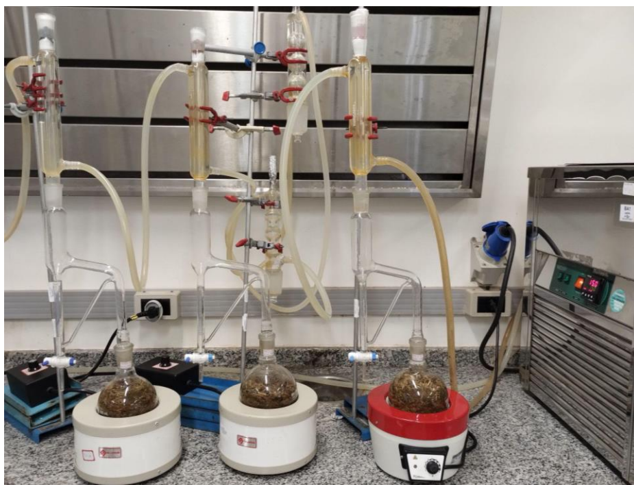
Figura 13 - Sistema de extração por hidrodestilação da parte aérea de Egletes viscosa , em triplicata
