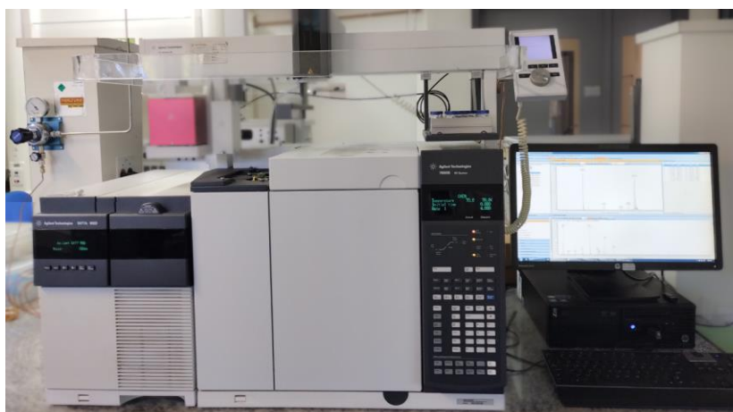
Figura 15 - Equipamento de CG-EM utilizado para a análise qualitativa e quantitativa dos óleos essenciais de Egletes viscosa
