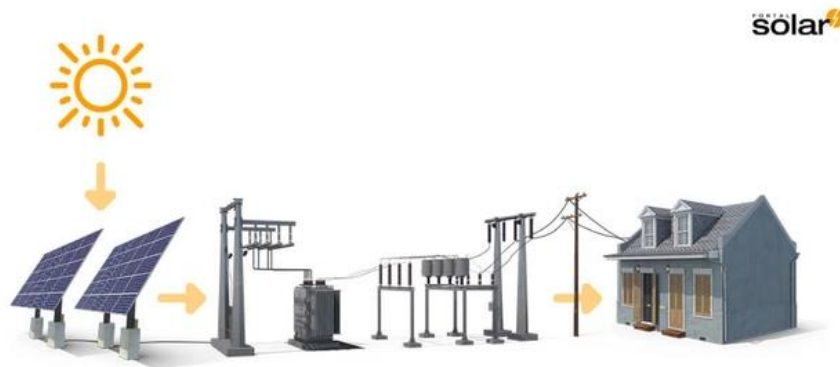
Figura 6 - Esquemático do processo de geração por parques fotovoltaicos até a rede de distribuição elétrica.
