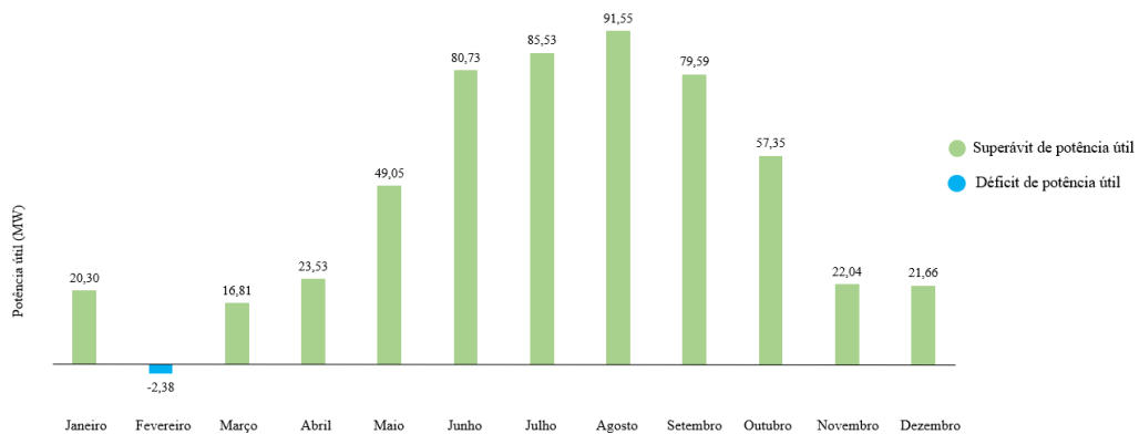
Figura 64 – Balanço mensal entre potência demandada (Planta H_2 ) e potência disponibilizada (FV + EOL).
