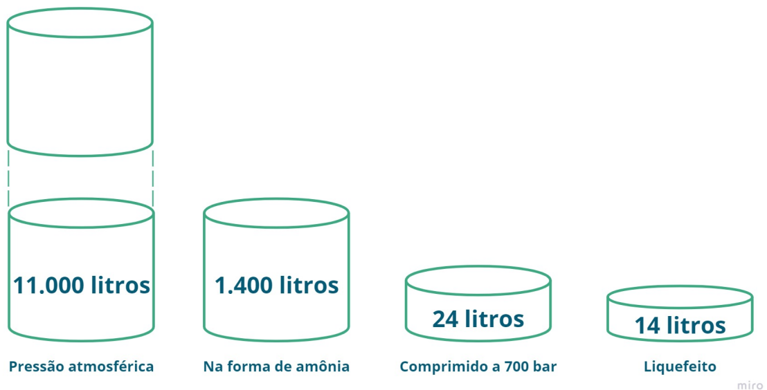
Figura 10 – Volume de armazenamento para 1 kg de hidrogênio.
