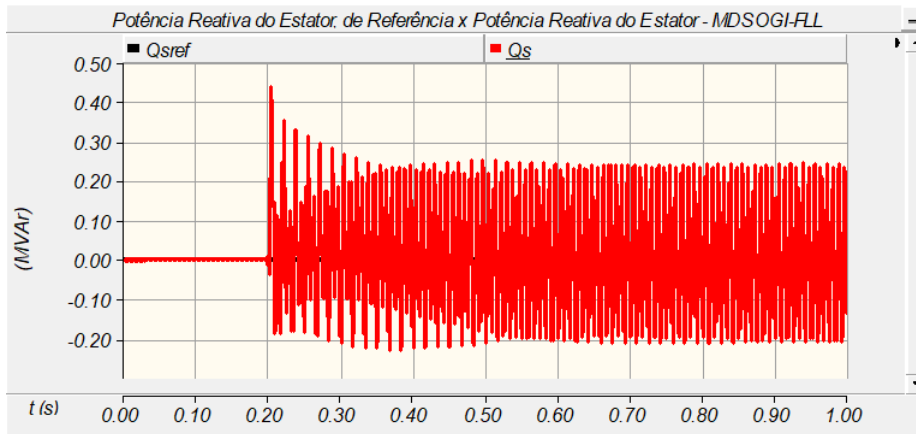
Figura 71 – Relação entre Potência de Reativa de Referência e Potência Reativa Medida, com MDSOGI-FLL
