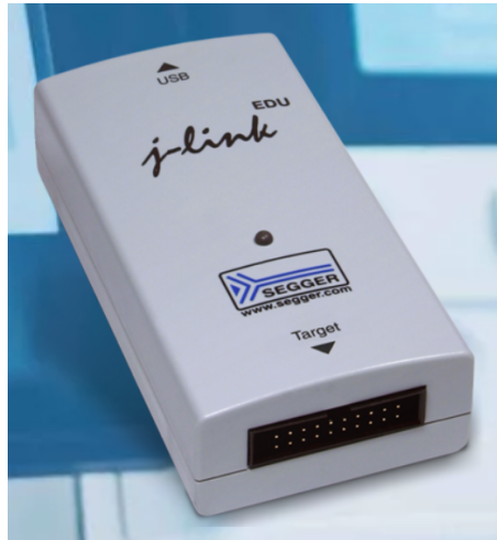
Figura 24 – Sonda de debug Segger J-Link
