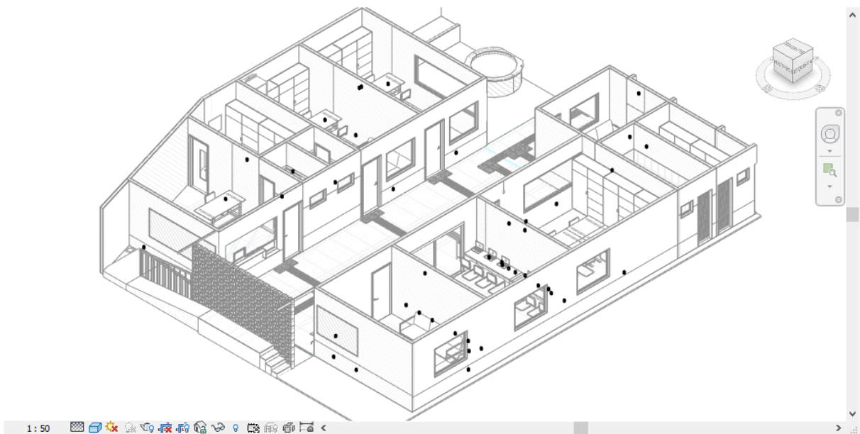
Figura 16 - Vista isométrica das tomadas do setor administrativo
