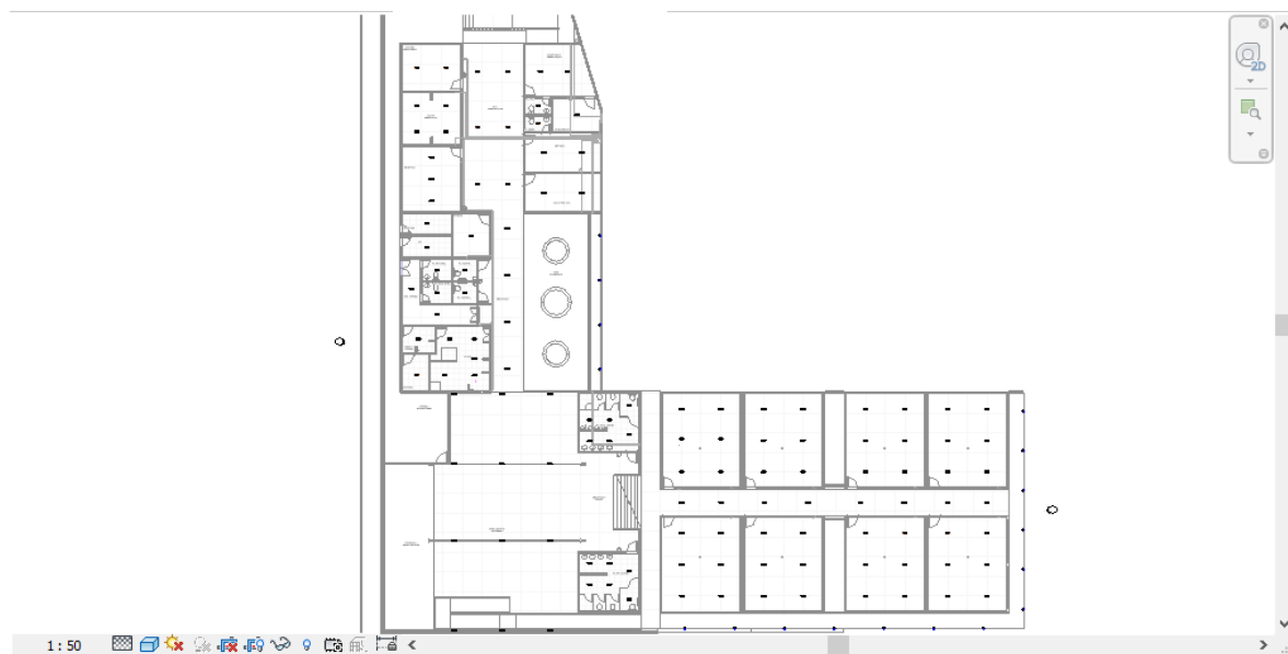
Figura 11 - Planta baixa com alocação das luminárias
