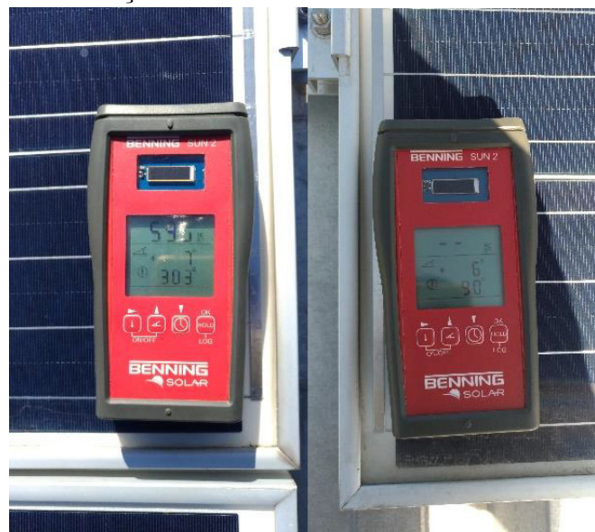
Figura 11 – Inclinação dos módulos
