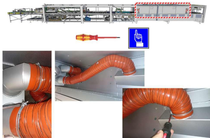
Figura 34 - Substituição das mangueiras de ar quente
