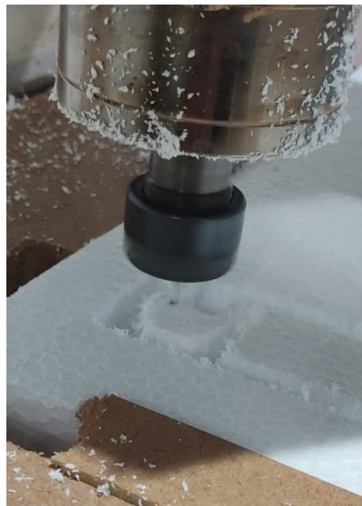
Figura 8 – Fabricação do modelo EPS em fresadora CNC
