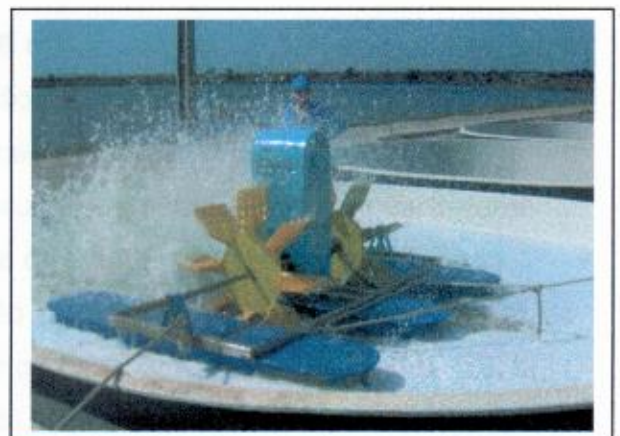
FIGURA 7 - Caixa de fibra de vidro utilizada para o tratamento com aeração da solução de descarte utilizada na despesca.
