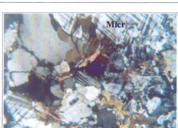
Fotomicrografia 4.2 – Mostrando a parte fêlsica com plagioclásio, microclina, muscovita, quartzo e biotita. Nicóis cruzados com aumento de 2,5mm.
