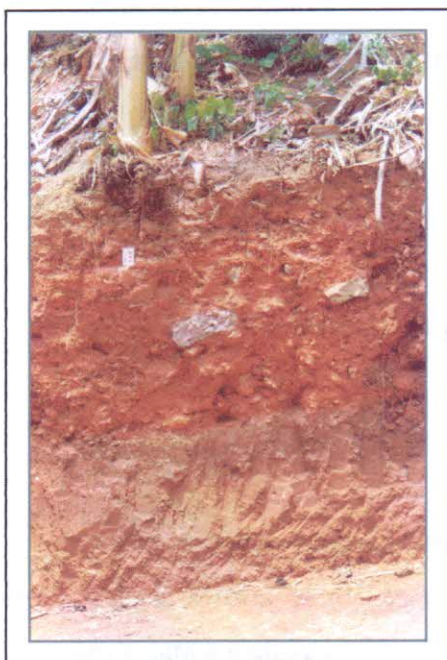
Foto 5.4 – Perfil de solo coluvionar, mostrando blocos e matacões, todos os tipos de rocha dentro dessa matriz argilosa.
