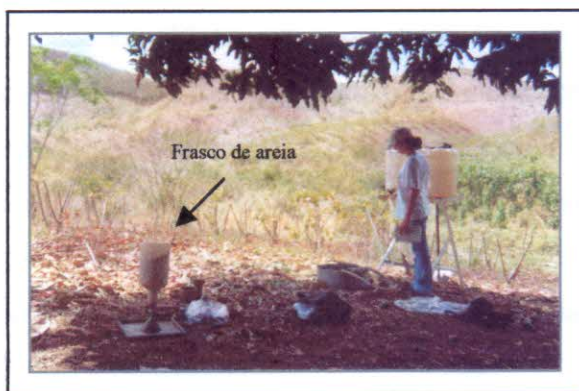
Foto 2.2 – Ensaio de massa específica aparente do solo, juntamente com o frasco de areia.
