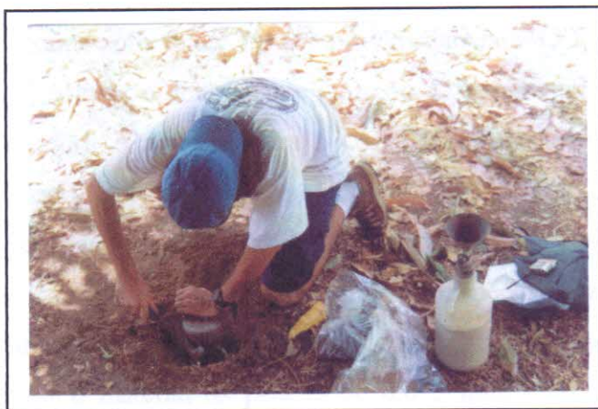
Foto 2.4 – Coleta de amostra de solo indeformada no campo para o ensaio de permeabilidade.
