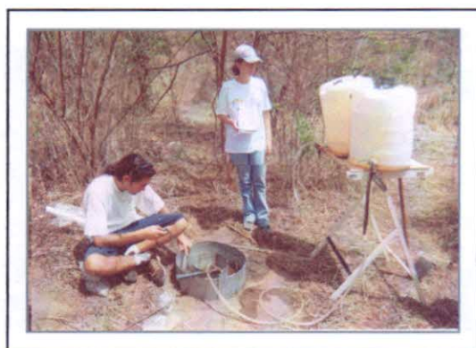
Foto 2.1 – Ensaio de infiltração no campo.
