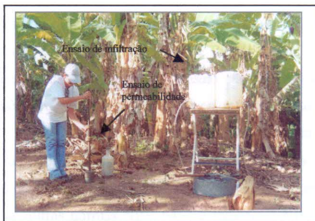
Foto 2.3 – Ensaio de permeabilidade juntamente com o ensaio de infiltração.
