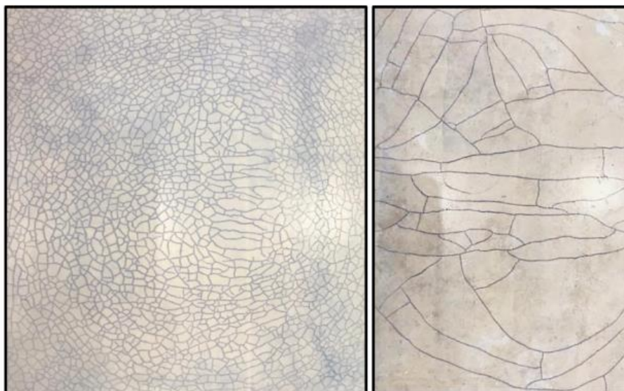
Figura 4 – Detalhes de gretamento observados em esmaltes cerâmicos
