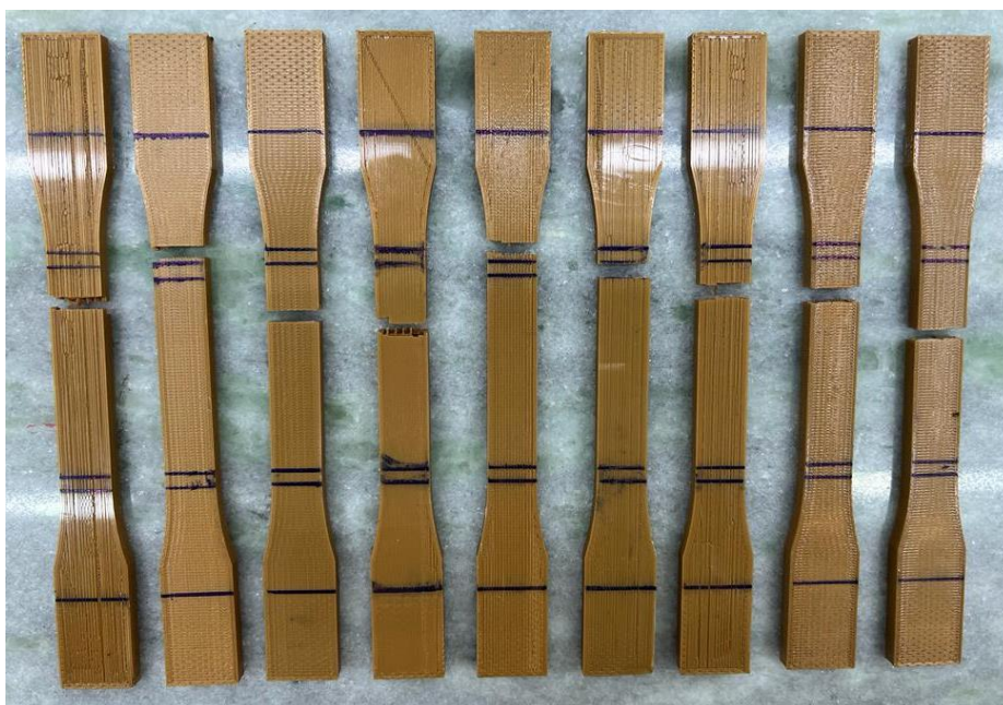
Figura 46 - Corpos de provas 10 a 18 após o ensaio
