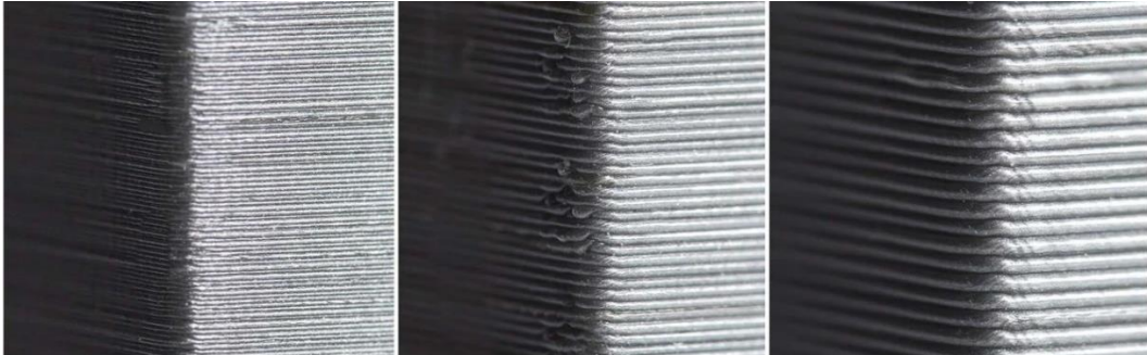
Figura 10 – Efeito da Altura de camada em uma impressão 3D na superfície da peça
