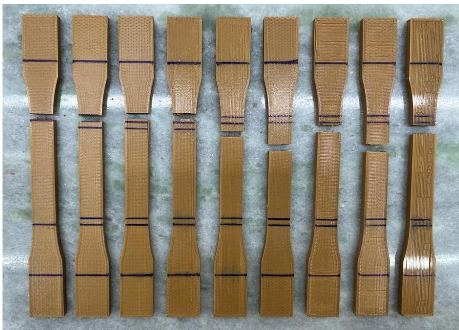
Figura 45 - Corpos de provas 1 a 9 após o ensaio
