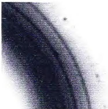
Figura 36 - Formação de anéis no padrão de difração de raios X ocasionado pela presença de cristais de gelo na amostra (Disponível em <http://www.riboworld.com/jmh/jmhs-hexaice.html#anhiceeff>).
