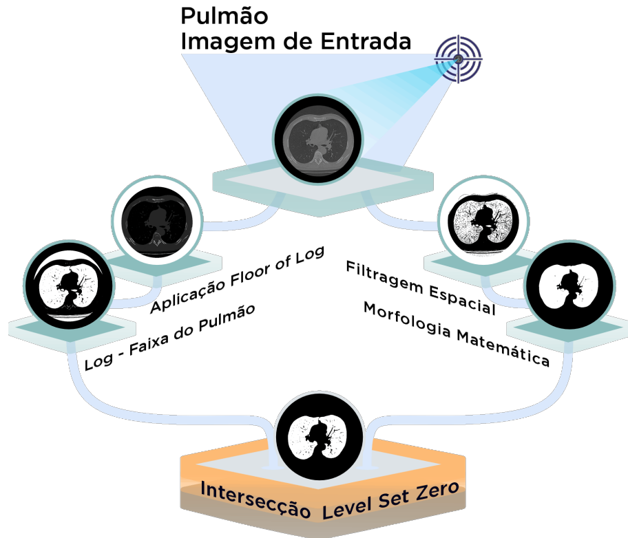
Figura 9 – Exemplo da inicialização proposta aplicada na detecção da região dos pulmões para inicialização do level set zero em imagens de TC do tórax.
