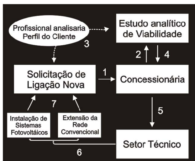
Figura 5 – Fluxograma do Pré-Atendimento elétrico a clientes rurais.
