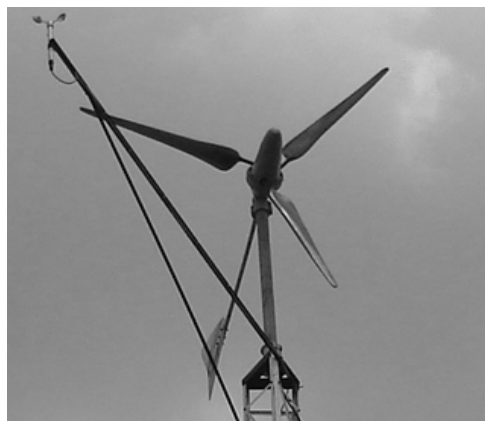
Figura 10 – Gerador eólico e anemômetro
